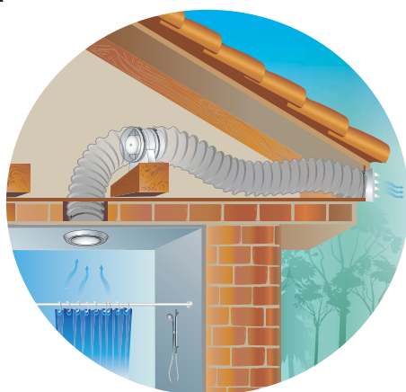
VKOk1 fan cottage ventilation example
